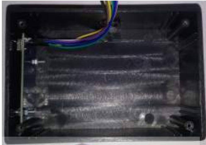
Gambar 3.25. Menyatukan RFID-RC522 pada Wadah
