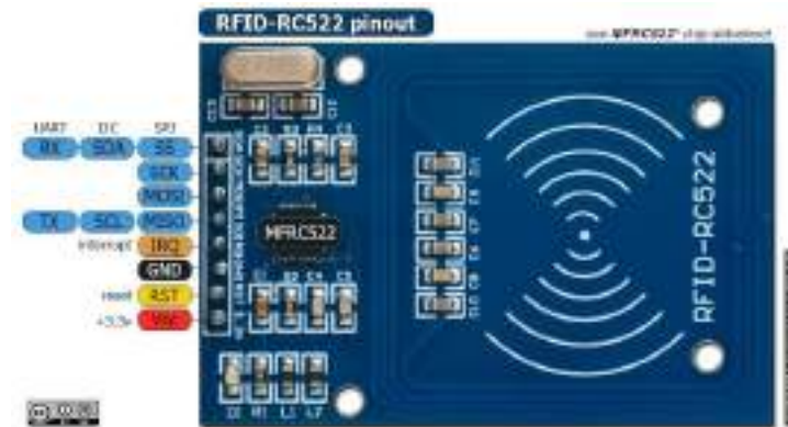
Gambar 2.4. Skematik Pin RFID-RC522
